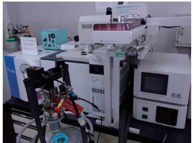
図6 P&T-GC/MS （パージ&トラップーガスクロマトグラフ質量分析装置）
