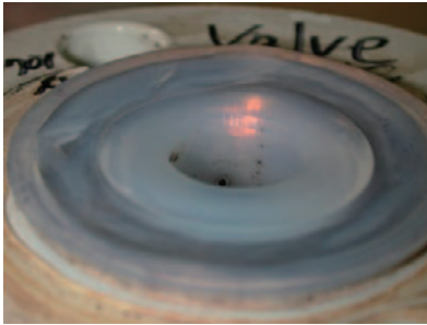
図17 フレア面の変形
