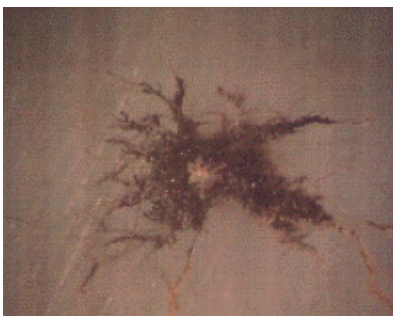
図9 ツリー現象 (光学顕微鏡写真)
