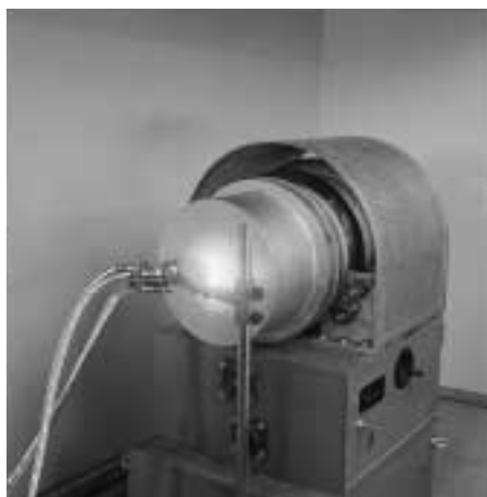
写真1 バーナー式回転浸食試験炉
