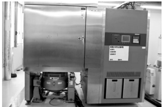
写真3 恒温恒湿槽付加振システム
