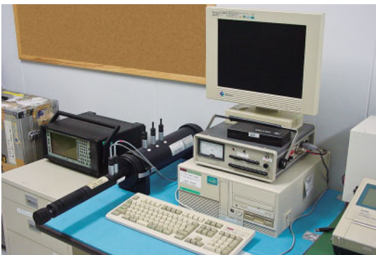
写真4 垂直入射吸音率測定システム
