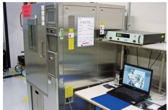
写真6 制振性測定システム
