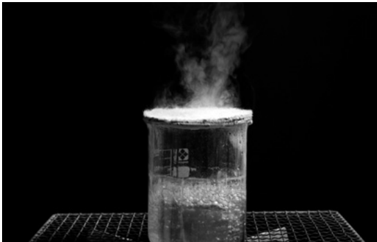
写真3 Pyrogel™ XTの水蒸気透過性
