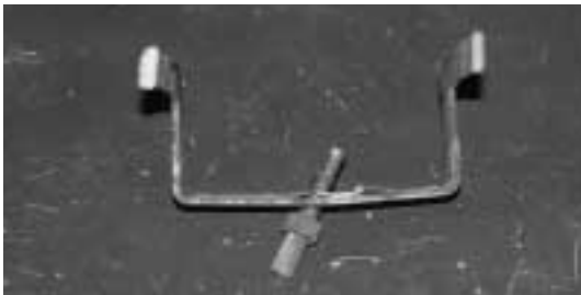
写真3 試験後 (バネ板厚0.6mm)
