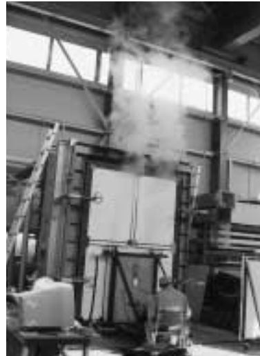
写真3 片面加熱試験 加熱中
