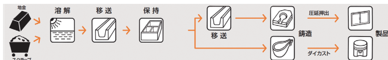
図1 アルミニウム製品の製造工程
