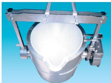
図2 使用例1 アルミ溶湯取鍋
