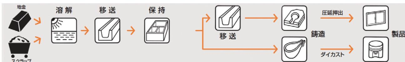
図1 アルミニウム製品の製造工程
