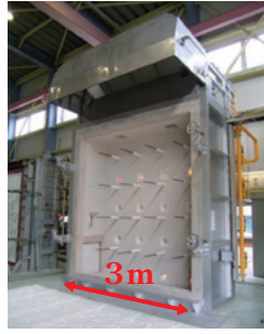
図11 大型壁試験炉写真
