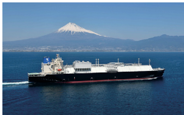
図3 JMU 殿建造のSPB®方式大型LNG船(写真提供:JMU 殿)
