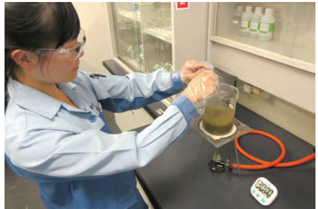
図7 ロックウールの煮沸溶出の様子
