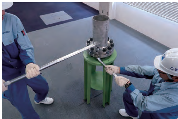
図7 ASME PCC-1とJIS B 2251の締付手順比較
