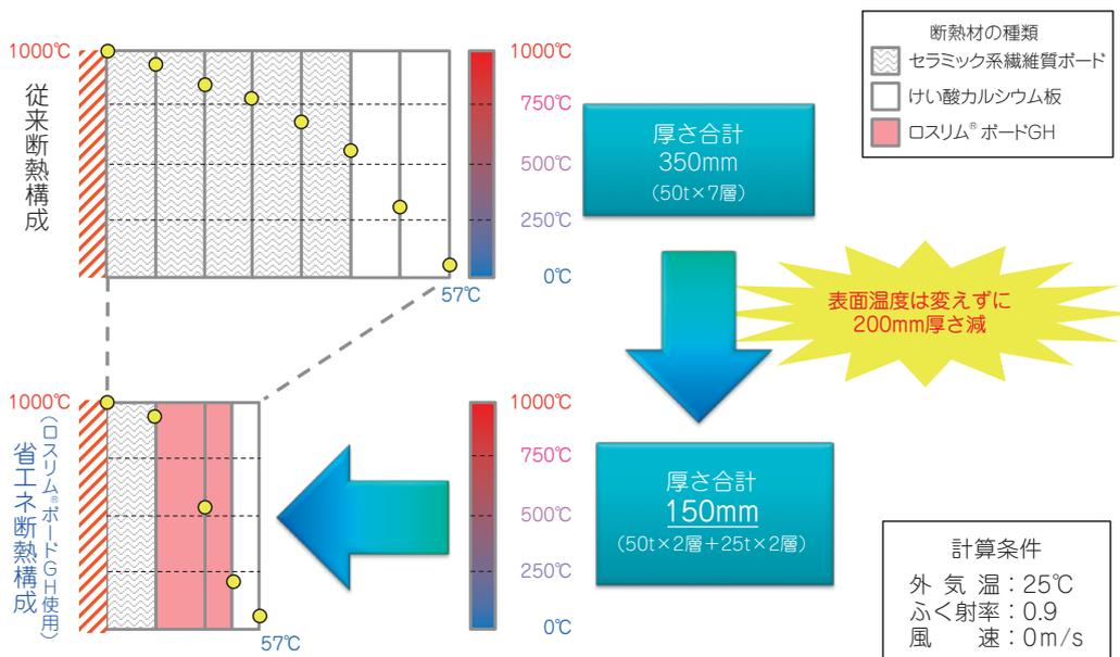
図6 コンパクト化の断熱材構成例
