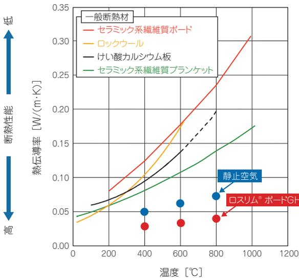
図2 各種断熱材との熱伝導率の比較
