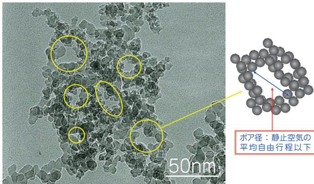
図3 「ロスリム® ボードGH」の内部構造 (TEM像)
