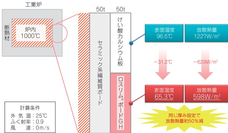
図5 省エネルギー断熱材構成例
