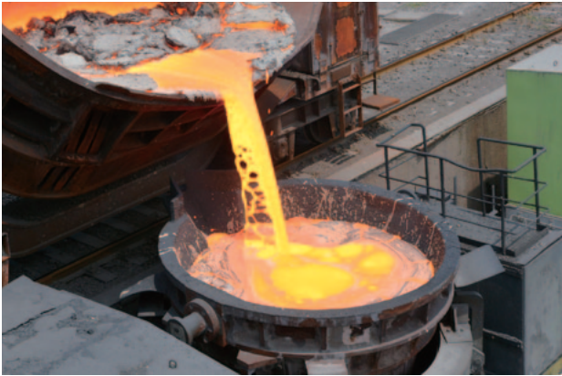
図7 熔融状態の高炉スラグ
