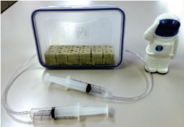
図5 ロックウール培地を使用した宇宙実験装置の模型
