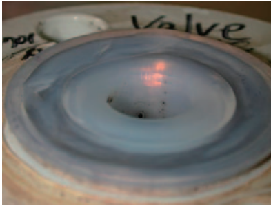
図17 フレア面の変形
