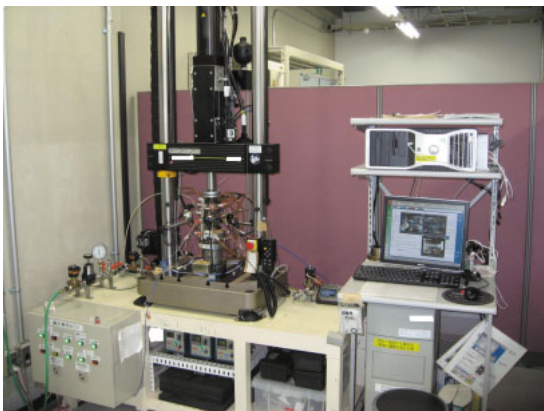
写真5 油圧疲労試験機
