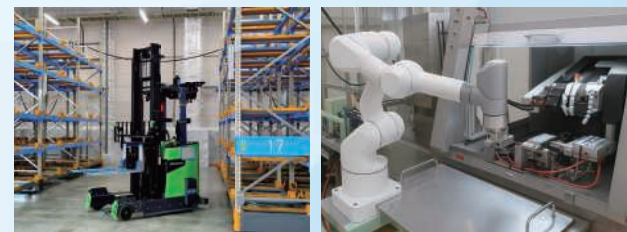
鶴見工場厚生棟での無人搬送フォークリフト 手作業の自動化に導入された協調ロボット
