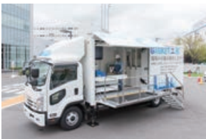
ガasket加工用移動式サービスカー
