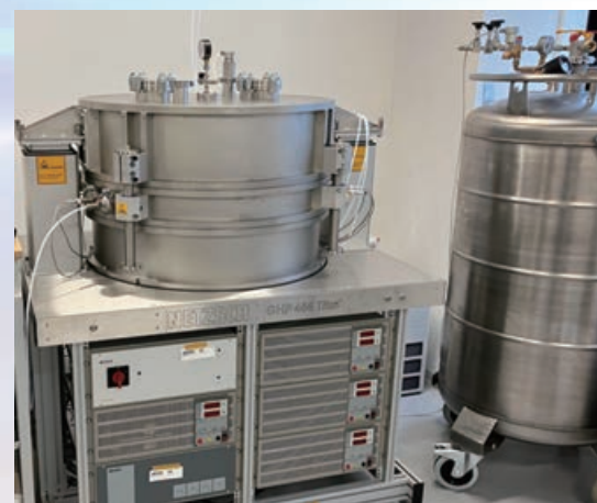
極低温熱伝導率測定装置
