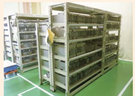
袋井工場の倒壊防止策を施した保管棚
