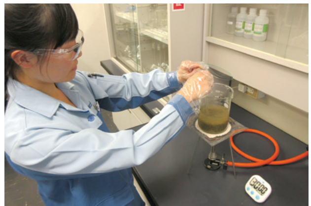
図7 ロックウールの煮沸溶出の様子
