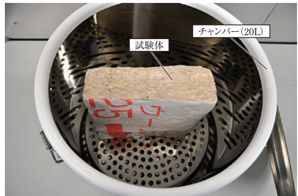
図3 ロックウール製品の試験体をチャンバーへ設置した様子
