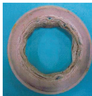
図2 花咲き現象によるガスケットの破損事例
