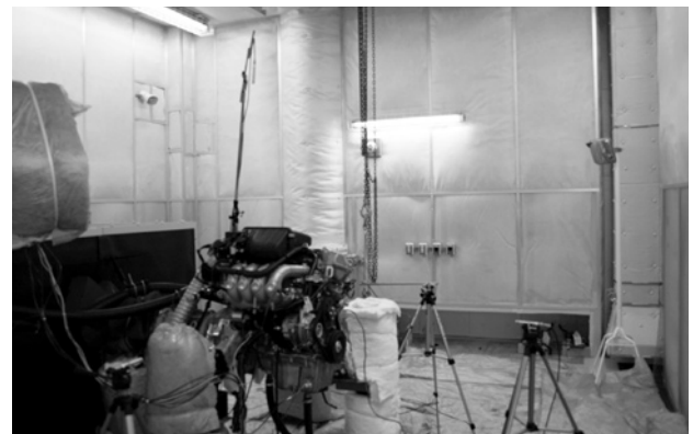
図 1 計測エンジンベンチ室
