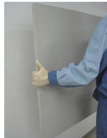
写真3 ロスリムボードGH大板のハンドリング (厚さ25mm×幅820mm×長さ850mm)
