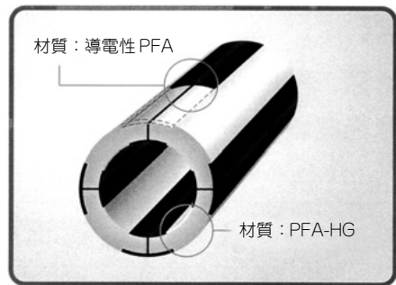
図1 チューブ断面図
