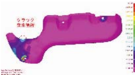
図9 インサルカバー初期形状解析結果
