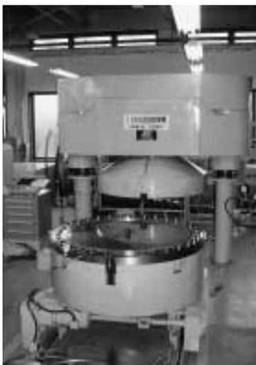
写真1 10MN油圧式圧縮試験機
