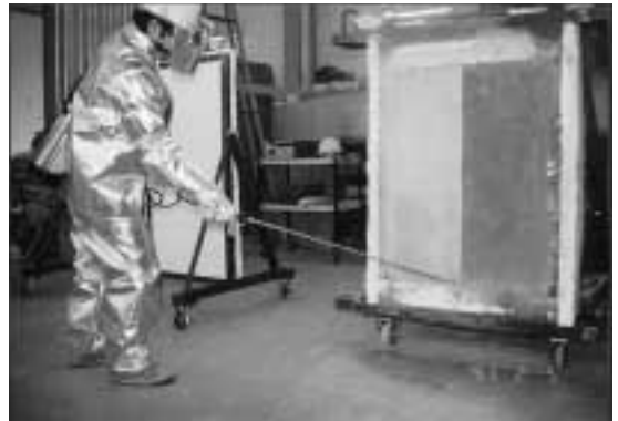
写真4 片面加熱試験 塩水噴霧中
