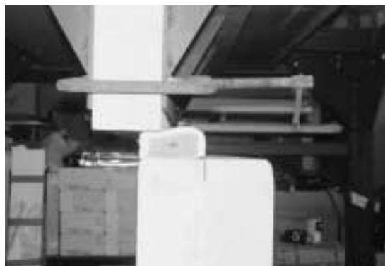
写真2 メンシンメジの変位追従性試験
