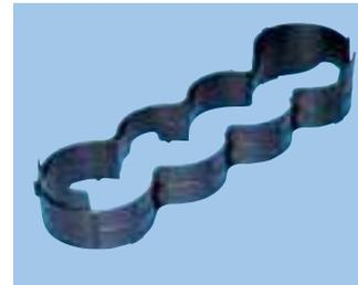
エンジン内部に挿入して、燃費向上に貢献する樹脂部品です。冷却水の流れを制御することで、シリンダー壁温を均一に保ちます。
